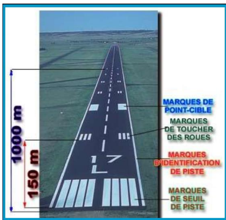
Figure.1-9 : marquages au sol
