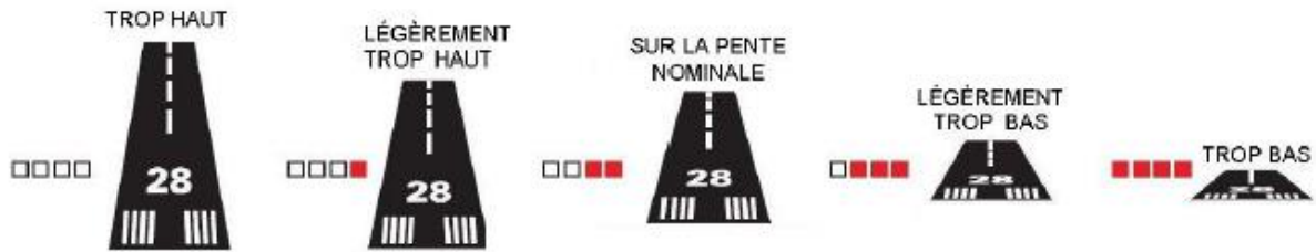
Figure.1-19 : Dispositif d'un PAPI
