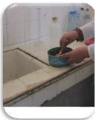
Photo 5 - préparation de la pâte saturée (sol-eau distillée)
