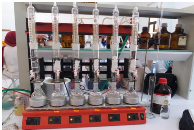
Photo 06: Appareil d'extraction du modèle Soxhlet
