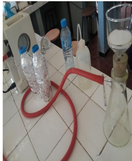
photo 04 : dispositif de filtration sous vide
