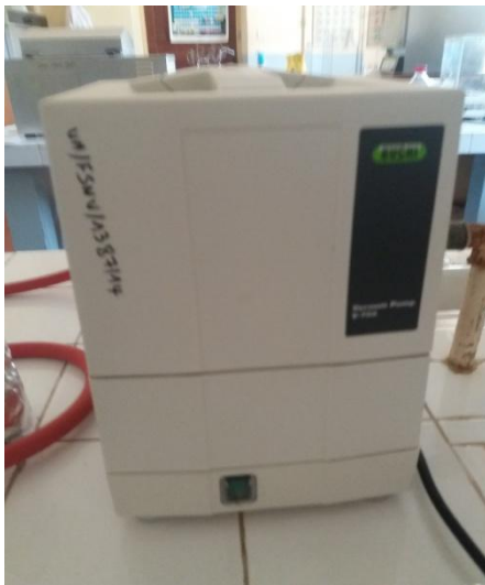
Photo 03 : Pompe à vide
