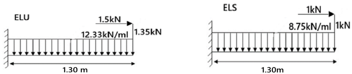
Figure 17. Schémas statiques en ELU et en ELS du balcon
