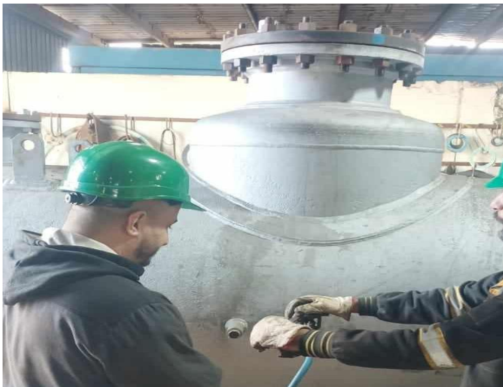
Figure II.2 : Teste de fuite par pressurisation par air instrument jusqu'à 4,5 bars.
