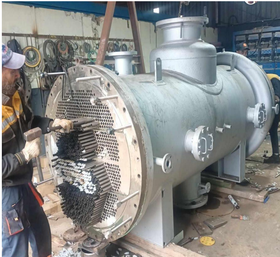
Figure II.5: Mise en place du faisceau tubulaire à l'intérieur de la calandre.
