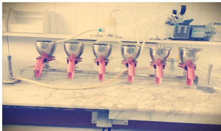
Figure. 3 Méthode de filtration. (Photo prise au laboratoire d'hygiène W.M)
