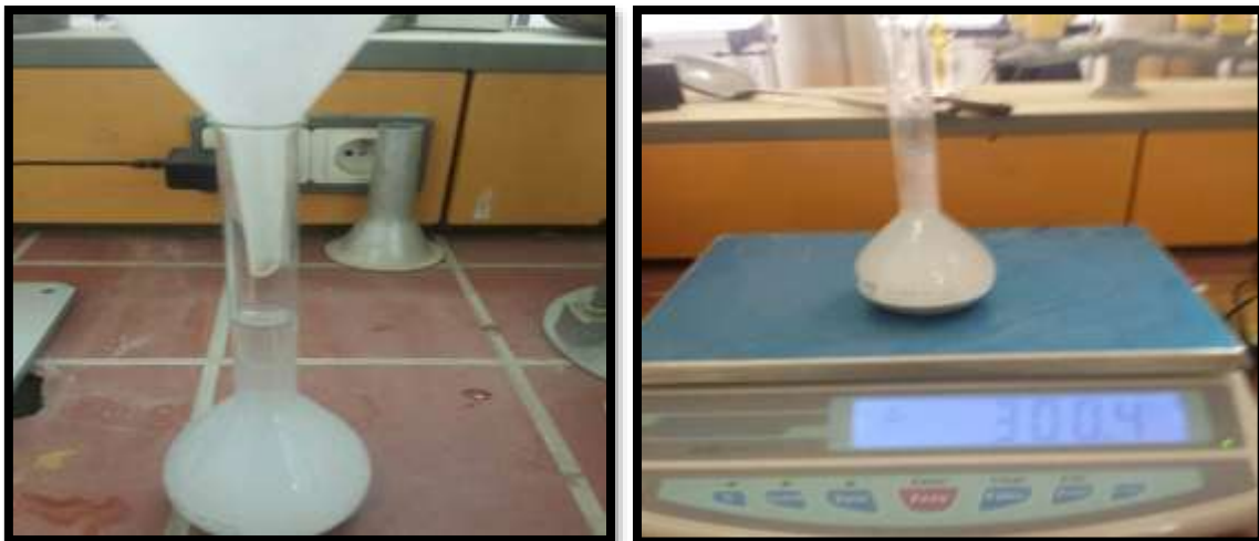
Figure II.4 : Masse volumique absolue de la perlite.
