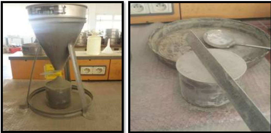
Figure II.1 : la masse volumique apparente du ciment.
