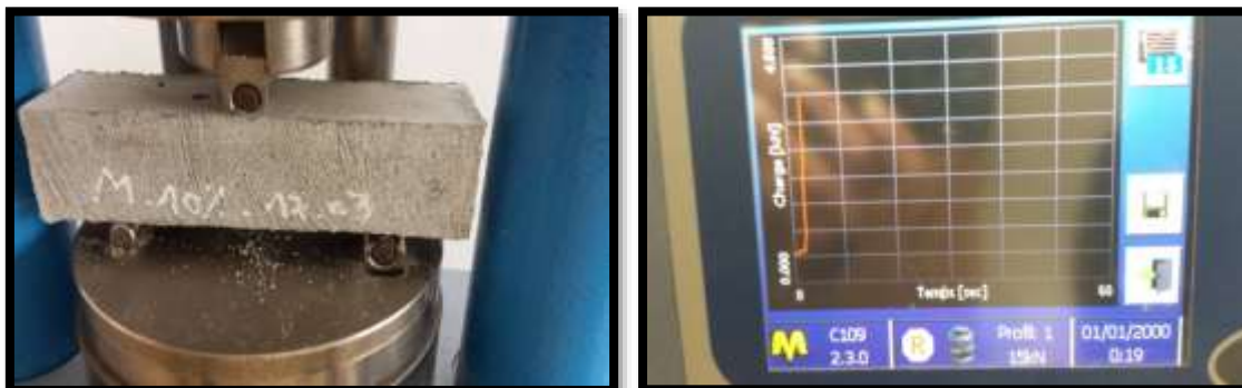
Figure II.15 : l'état des résultats après l'essai de résistance à la flexion.
