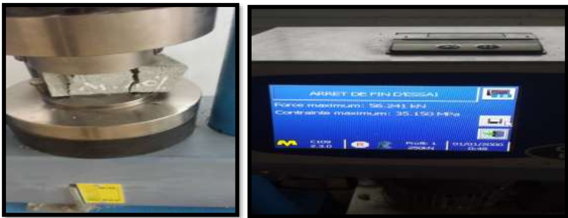
Figure II.17 : l'état des éprouvettes après la compression.
