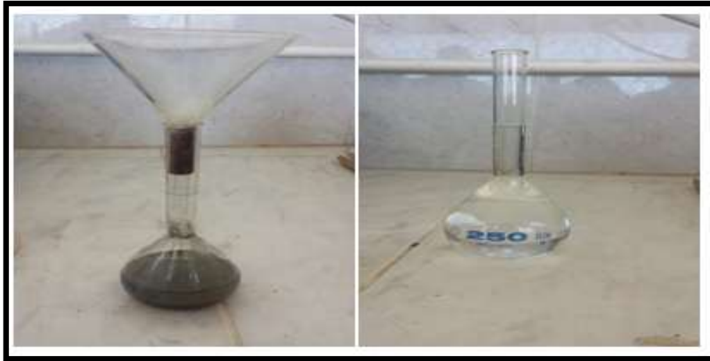
Figure II.2 : Masse volumique absolue du ciment CPJ CEM II 42.5 R.
