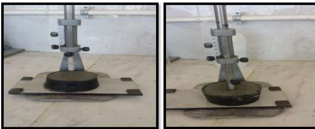
Figure II.3 : Mesure la consistance de la pâte de ciment.
