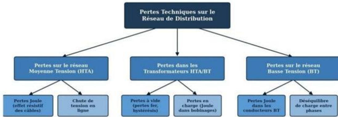
Figure I.5 : Classification des pertes techniques dans un réseau de distribution d'énergie électrique
