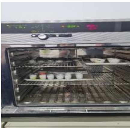
Figure 35 : Détermination de la matière organique des sols par séchage à l'étuve et par calcination au four à moufle ((Rouichi nour el Houda, 2025).
