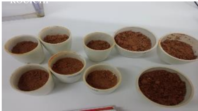
Figure 34 : sol après le séchage de l'étuve à 105°C (Rouichi nour el Houda, 2025).
