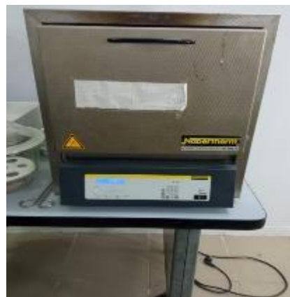
Figure 35 : Détermination de la matière organique des sols par séchage à l'étuve et par calcination au four à moufle ((Rouichi nour el Houda, 2025).
