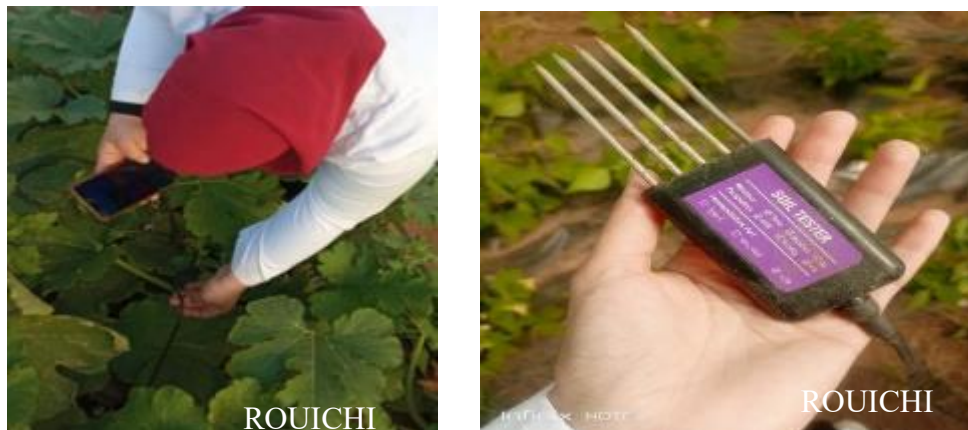
Figure 30 : Les mesures des paramètres physico-chimiques du sol à l'aide d'un capteur.
