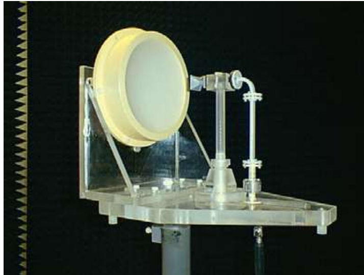
Figure.II.14.. Réflecteur parabolique diélectrique en chambre de mesure
