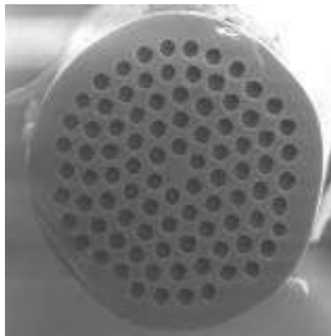
Figure.II.11: Exemple de fibre à cristal photonique
