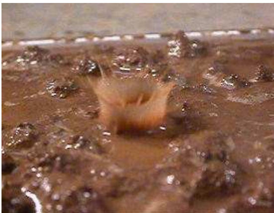
Planche 1: Rejaillissement du sol et de l'eau suite à l'impact d'une goutte d'eau, ou effet splash d'après (Le Bissonnais et al., 2002)
