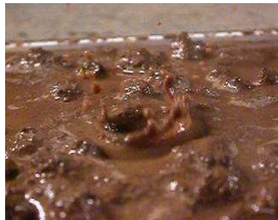
Planche 1: Rejaillissement du sol et de l'eau suite à l'impact d'une goutte d'eau, ou effet splash d'après (Le Bissonnais et al., 2002)
