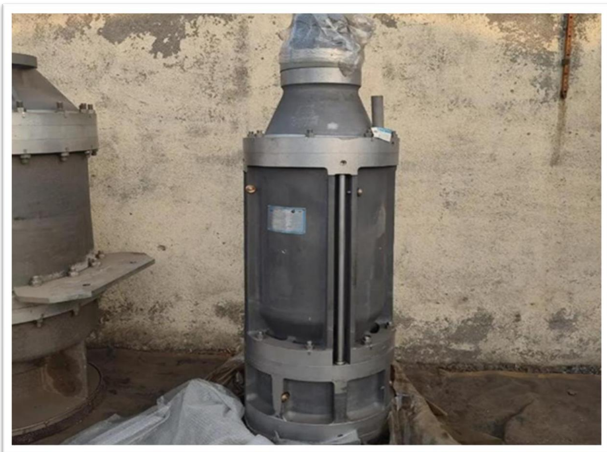
Figure I.3 : Pompe chargement GNL
