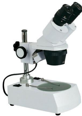
Figure. II.4. Microscope optique binoculaire pour le choix du monocristal
