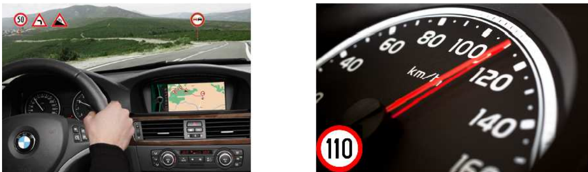
Figure.2. Exemple de résultats fournis par un TSR. Un panneau de limitation de vitesse (110 Km/h) est reconnu.
