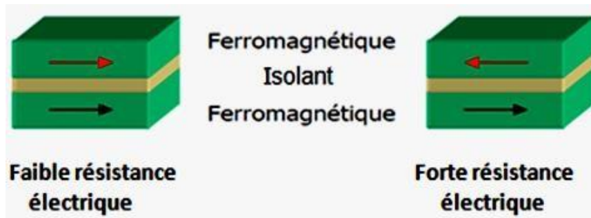
Figure I.12 : les deux états, parallèle et antiparallèle, dans une jonction tunnel magnétique
