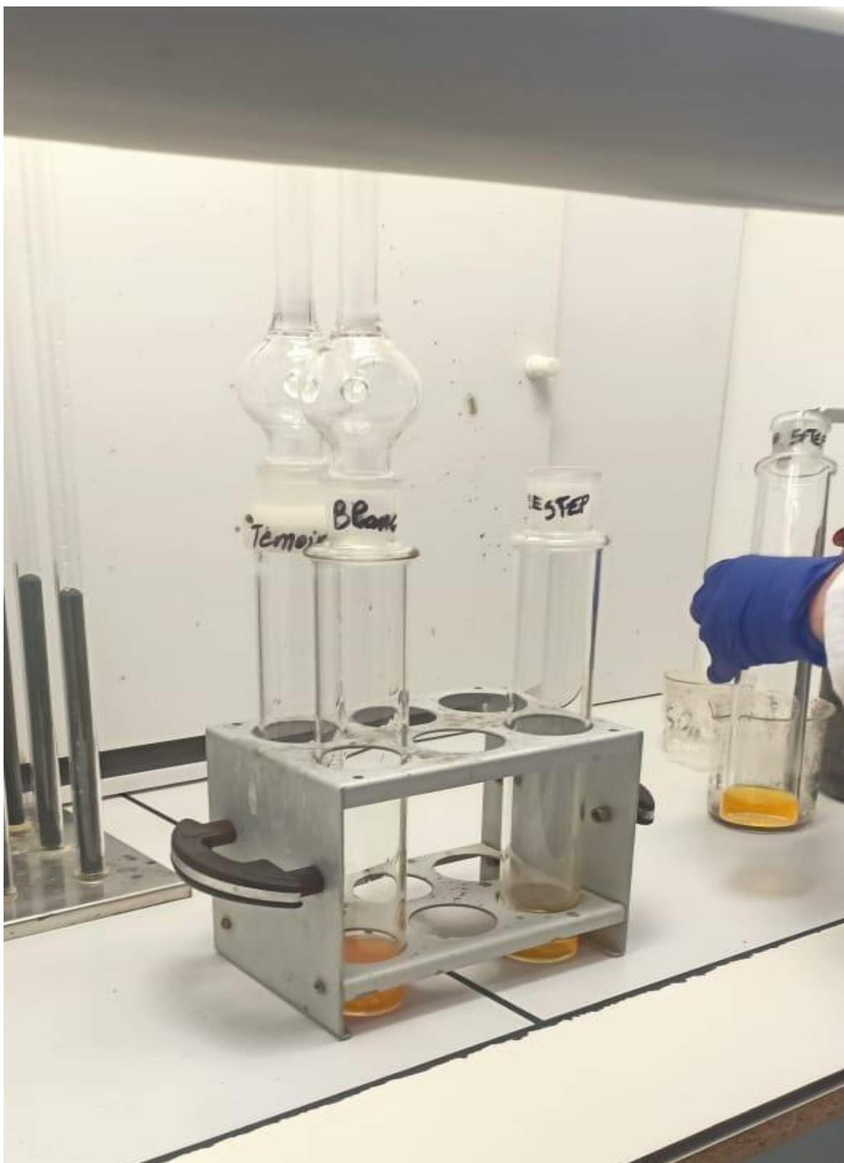
Figure 43. La couleur du réactif passe de l'orange (chrome) au vert (chrome) proportionnellement à la pollution.
