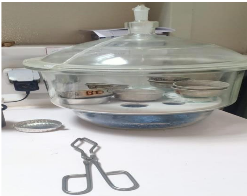
Figure39. Dessiccateur de laboratoire en verre contenant des capsules d'évaporation
