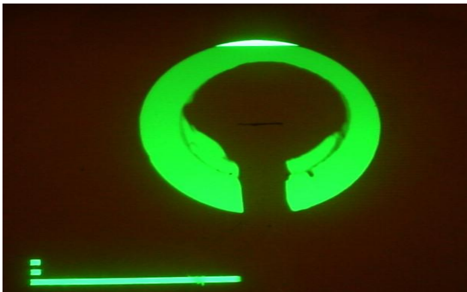
Figure (II.27) Image EBIC du transistor avec branchement de la jonction, base-émetteur barre=100 \mu\text{m} [10]
