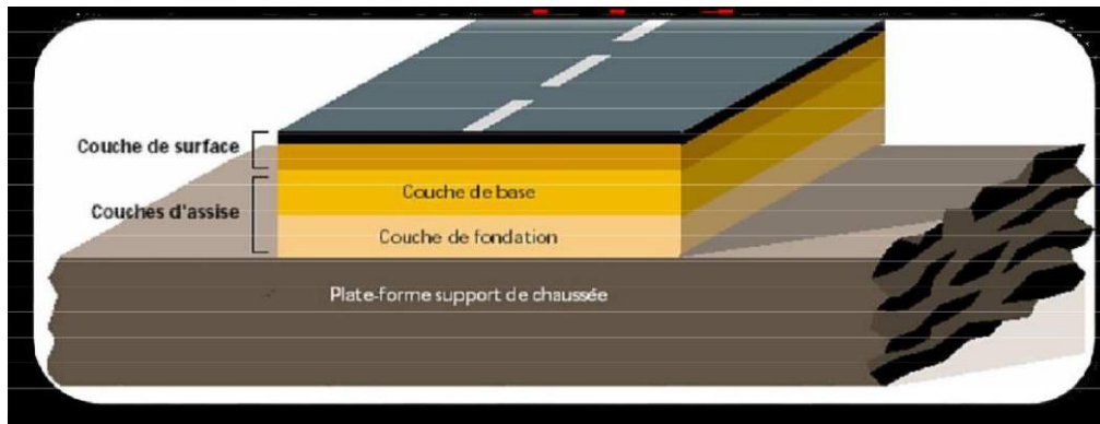
Figure V.1: Structure type d'une chaussée souple.
