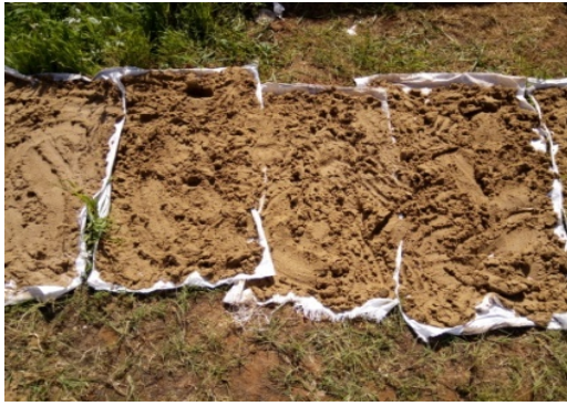
(D) : Séchage du sable à l'air libre
