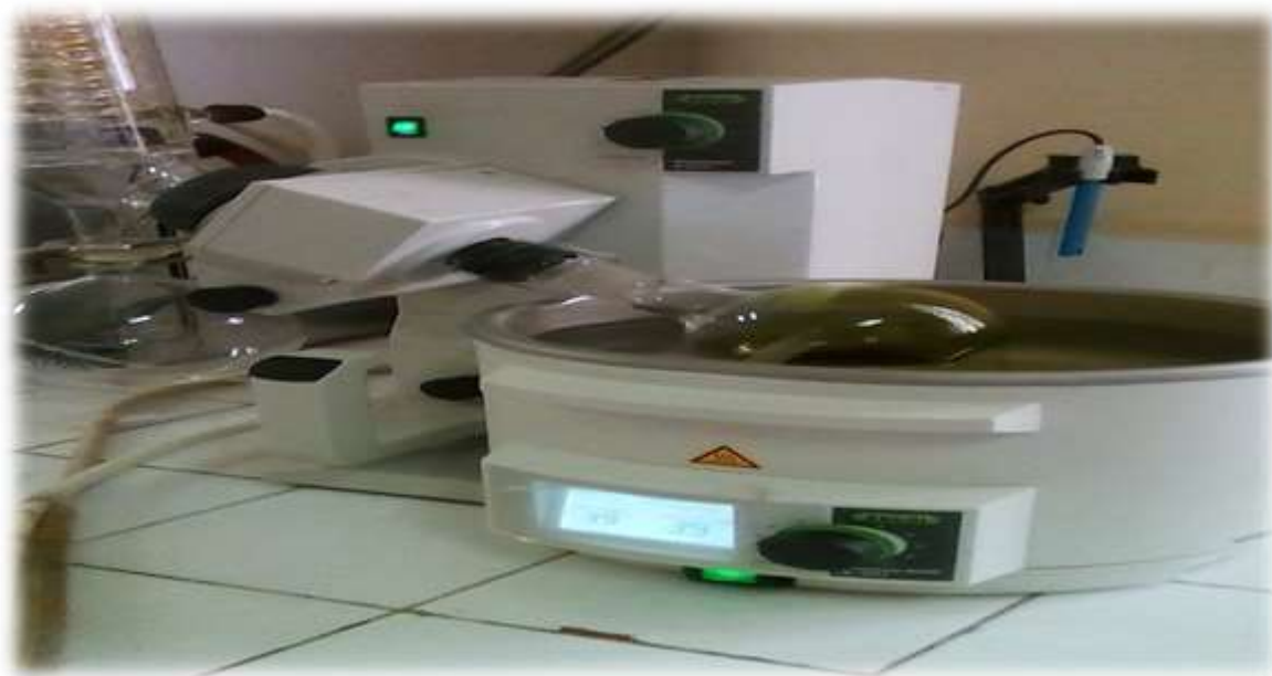
Figure 29 : Méthode de l'évaporation de l'extrait méthanolique dans l'appareille de rutavapeur
