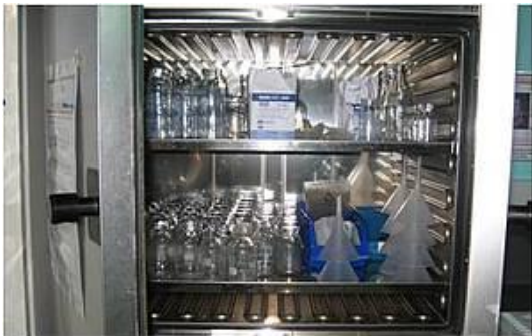
Figure 6: La verrerie est placée à l'étuve.
