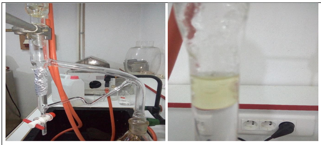
Figure 15 : Dispositif d'hydrodistillation de type Clevenger pour l'extraction des huiles essentielles d' Artemisia herba-alba .
