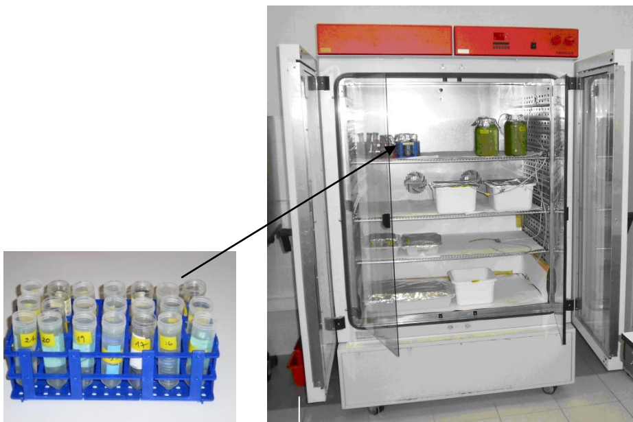
Photo 11. Chambre thermostatique utilisée pour l'élevage individuel au niveau de l'Institut d'Aquaculture de Torre de la Sal
