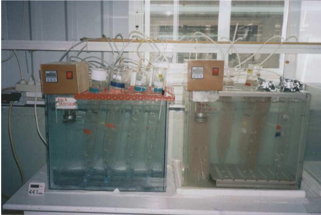
Photo 8. Incubateur utilisé pour standardiser l'éclosion des cystes utilisé au niveau de l'Institut d'Aquaculture de Torre de la Sal.
