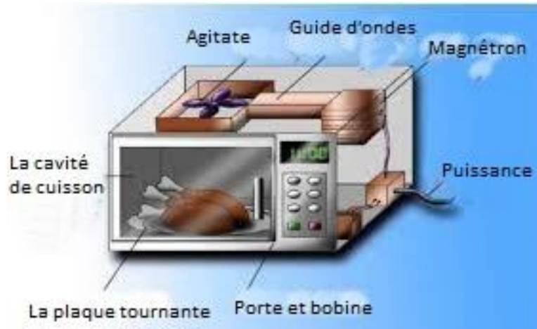
Figure 6 : Schéma d'un four micro-ondes ( Mathavi, 2013 ).
