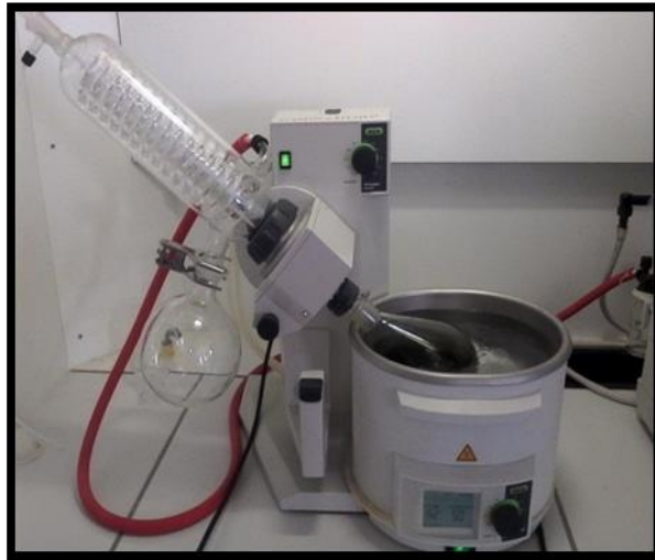
Figure17 : Passer l'extrait hydro-alcoolique sous rota-vapeur afin d'évaporer le solvant (méthanol)
