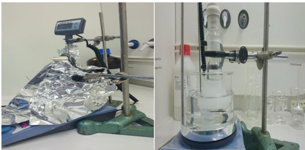
Figure IV.1: Image du procédé d'oxydation du périodate, avec et sans couverture de papier d'aluminium.
