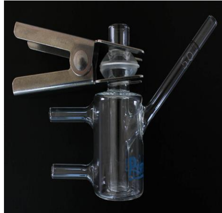
Figure IV.12 : Etude de cinétique de la perméabilité transdermique in vitro par cellule de diffusion verticale de Franz.
