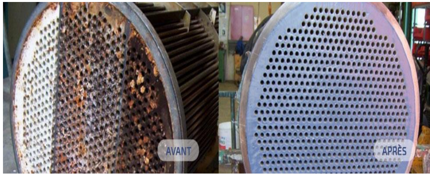
Figure III.12: Exemples d'échangeurs sale et propre.
