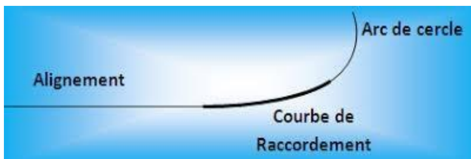
Figure V. 1 : Éléments du tracé en plan.
