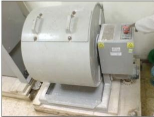
Figure X. 6 : Matériels d'essai Los Angeles.
