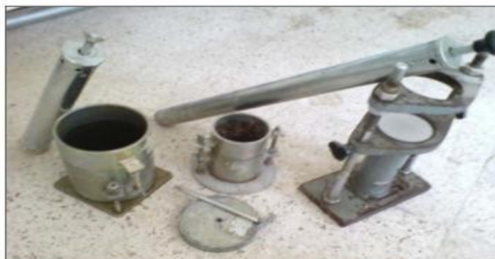
Figure X. 4. : Matériels d'essai Proctor
