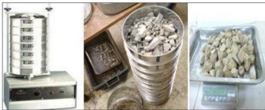
Figure X. 1: Matériels de l'analyse granulométrique.
