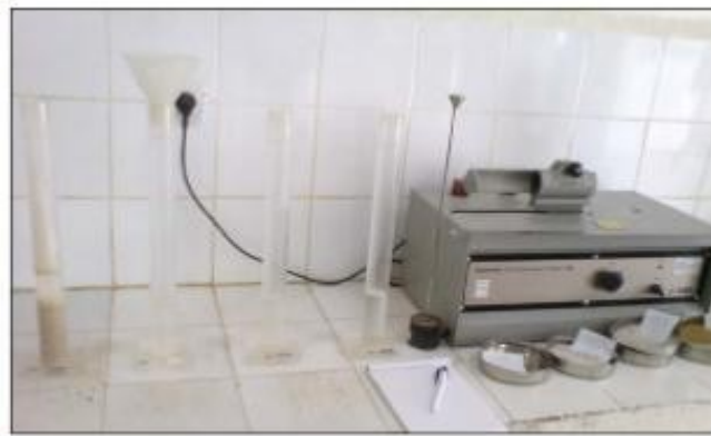
Figure X. 2: Essai d'équivalent de sable.
