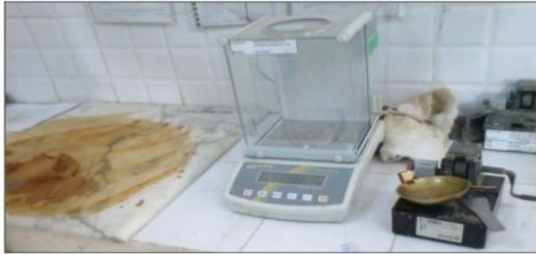
Figure X. 3: Matériels pour mesurer la limite d'Atterberg.
