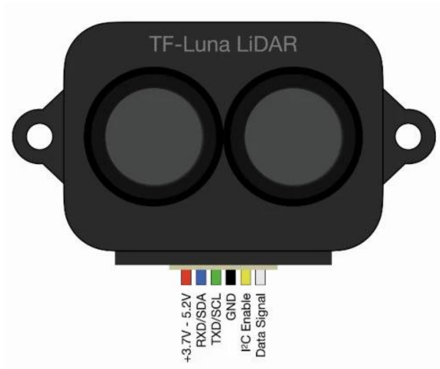
Figure A. 3 . LiDAR TF-Luna
