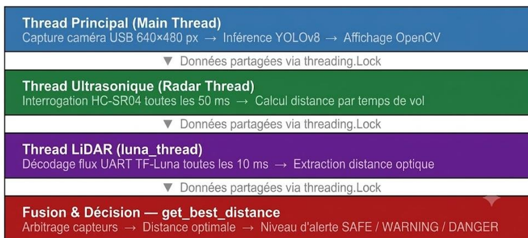
Figure 3. 7. Architecture multi-thread du système embarqué.
