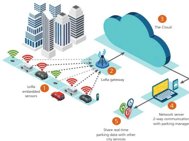
Figure 04 [15] : fonctionnement de la technologie LoRa
