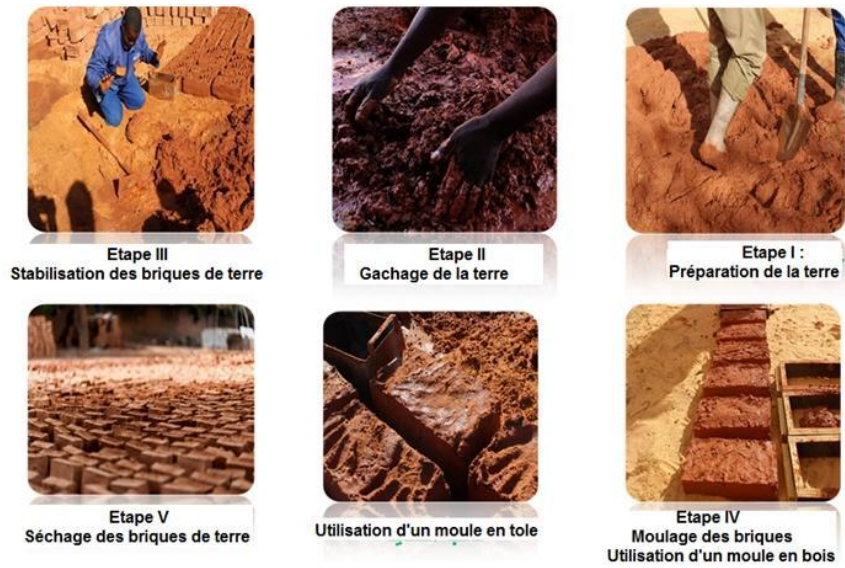
Figure 22 : Etapes de production des briques d'adobes ( tub ).
