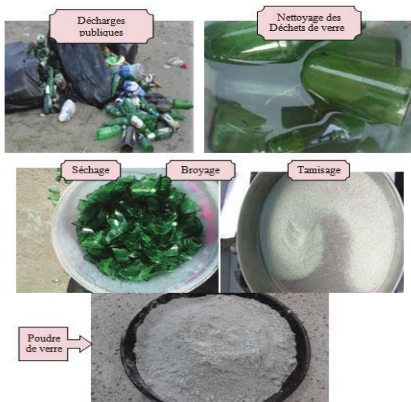
FIGURE 13 TRANSFORMATION DE DECHETS DE VERRE EN POUDRE DE VERRE [21]
