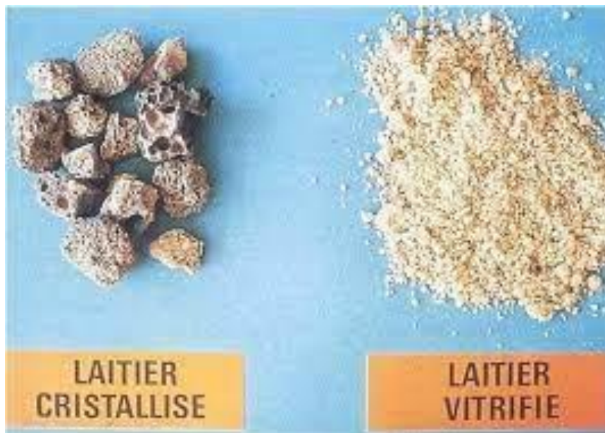
FIGURE 7 LE LAITIER DU HAUT FOURNEAU EN POUDRE
