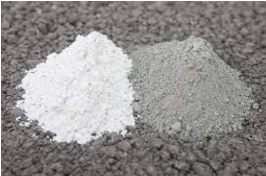
FIGURE 6 LE LAITIER DU HAUT FOURNEAU EN POUDRE
