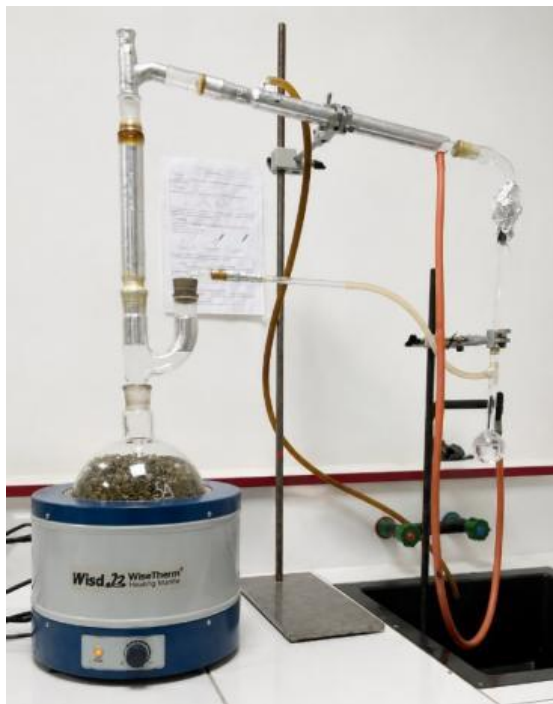
Figure 6. Montage d'hydrodistillation de type Clevenger utilisé pour l'extraction des huiles essentielles.
