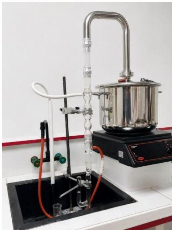
Figure 7. Vapo-distillateur de type SPRING A 105 12 Litres utilisé pour l'extraction des huiles essentielles
