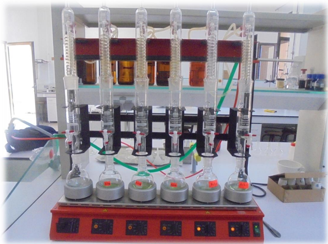
Figure n° 13: Appareil d'extraction des lipides totaux par chaud ( originale , 2016).
