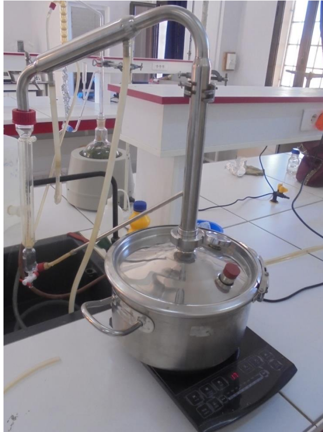
Figure n°9 : Extraction huile essentielle par entrainement de la vapeur ( originale , 2016)
