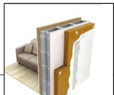
Figure 39 : Application d'un enduit sur un panneau isolant
