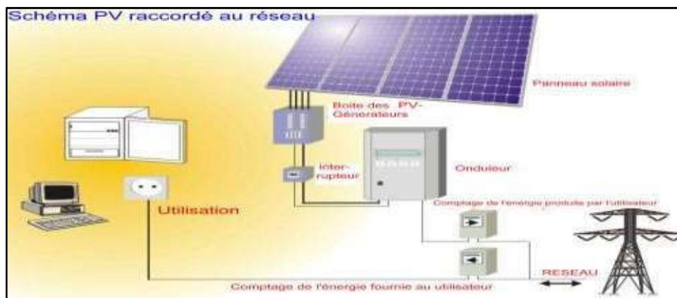
Figure 40 : Schéma PV raccordé au réseau
