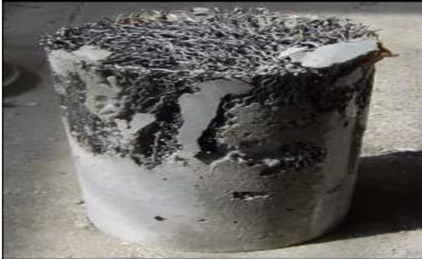
Figure 3.3 : Un exemple d'échec de la préparation à cause de manque de fluidité de coulis
