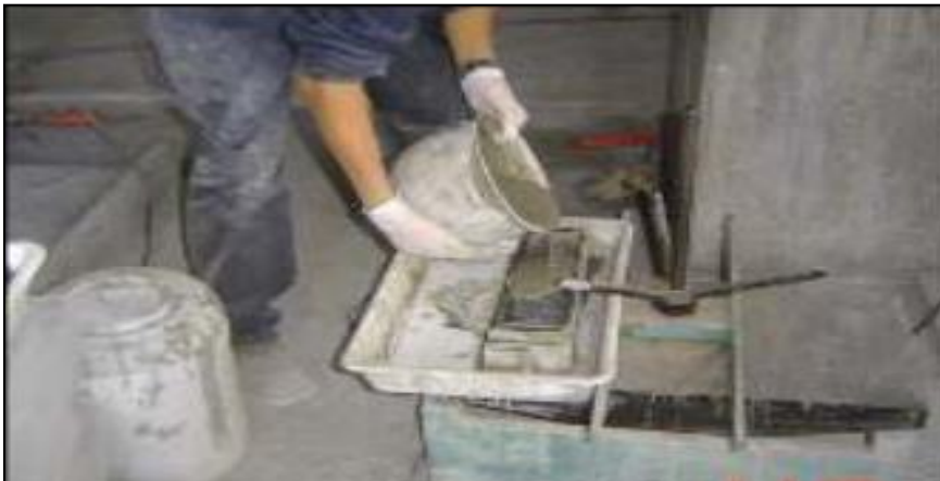
Figure 3.2 : Infiltration de coulis aidée par des vibrations externes
