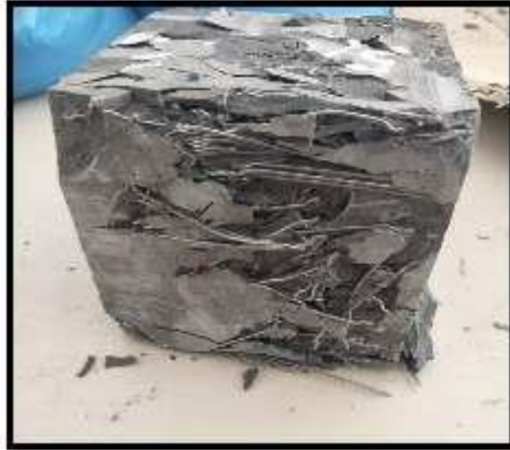
Figure 4.7 : Aspect des éprouvettes destinées à l'essai de compression
