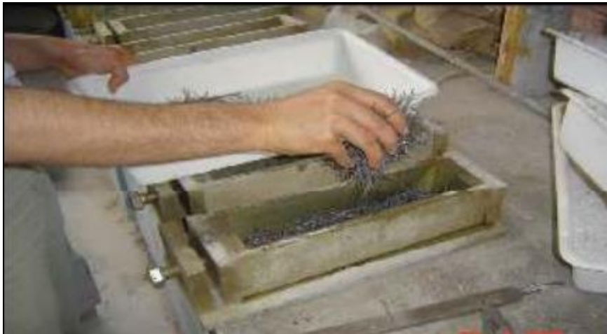
Figure 3.1 : Placement à la main des fibres d'acier dans un moule
