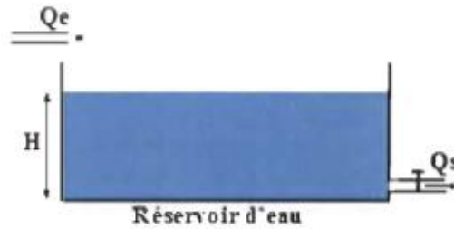
Figure II.1: Réservoir de stockage d'eau
