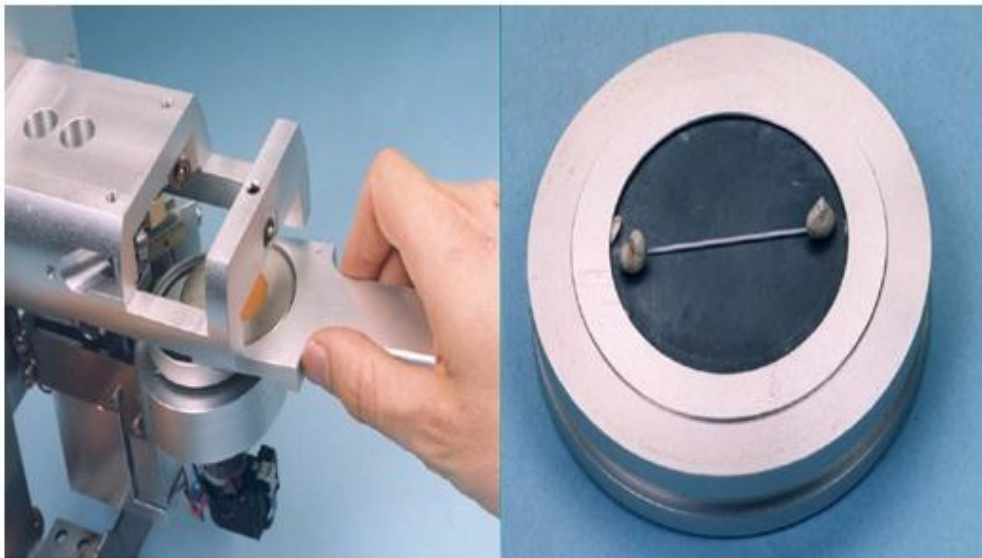
(1) : L'anneau du porte-échantillon est fixé sur le socle de préparation
