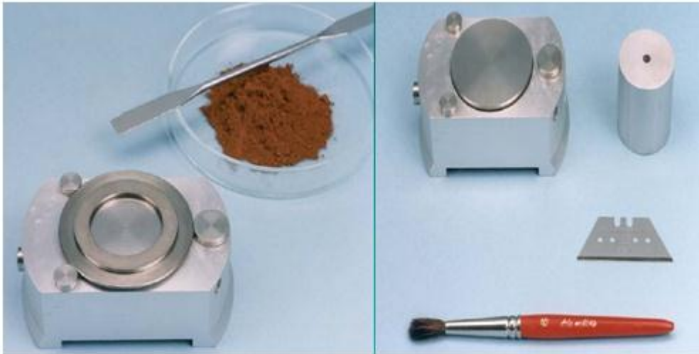
(1) : L'anneau du porte-échantillon est fixé sur le socle de préparation
