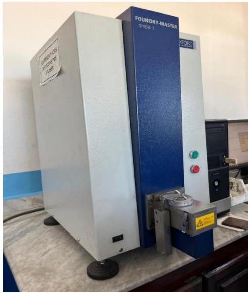
Figure 22: Spectrometer pour analyse chimique de matériaux.
