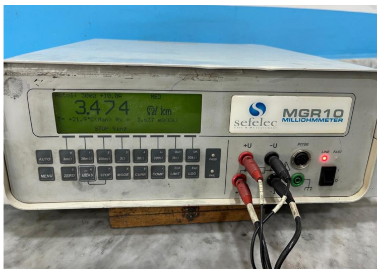
Figure 21: Millihommètre pour mesurer la résistance électrique.
