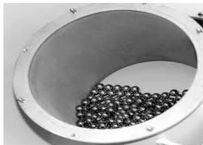
Figure III.2. Schéma simplifié d'un broyeur à boulets
