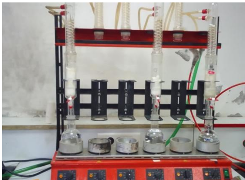
Figure08: l'appareil d'extraction Soxhlet.(photo réelle)
