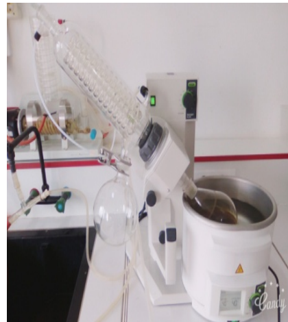
figure10. Evaporation dans un rota vapeur sous vide
