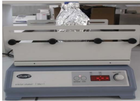
Figure 8. Mélange de l'échantillon avec les solvants
