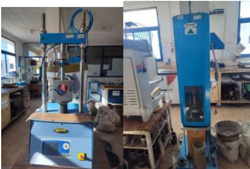
Figure 15 : Appareil utilisé dans l'essai de Marshall
