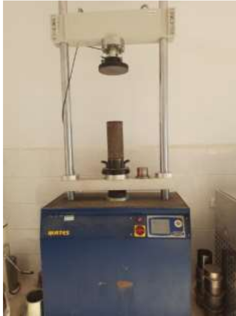
Figure 16 : Appareil utilisé dans l'essai Duriez
