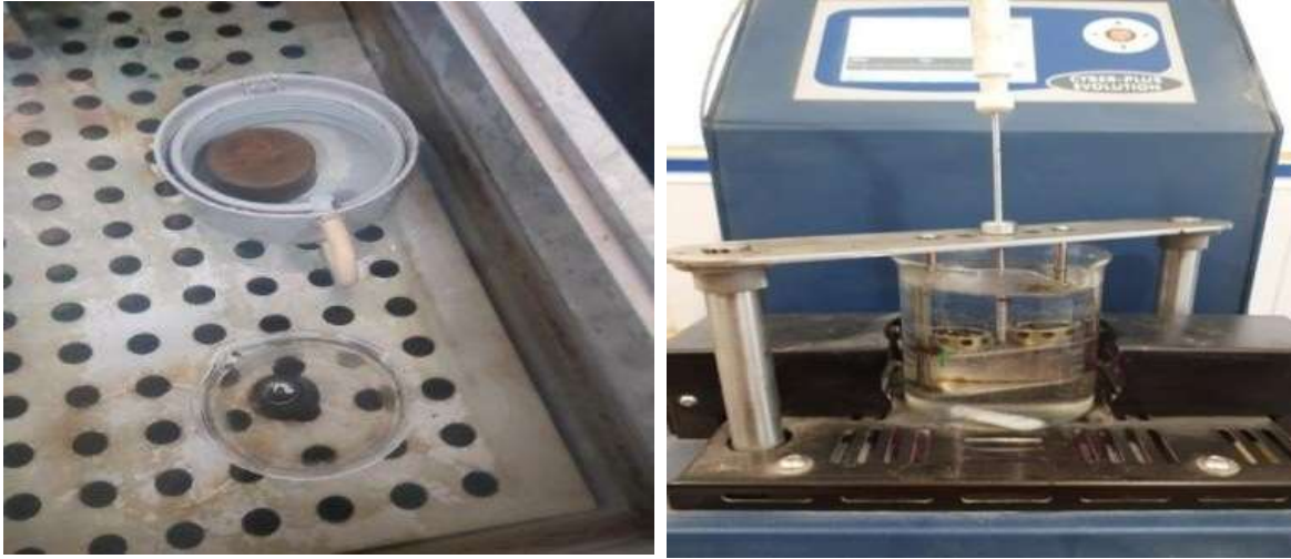
Figure 19 : Test du point de ramollissement du mélange bitume-fillers.
