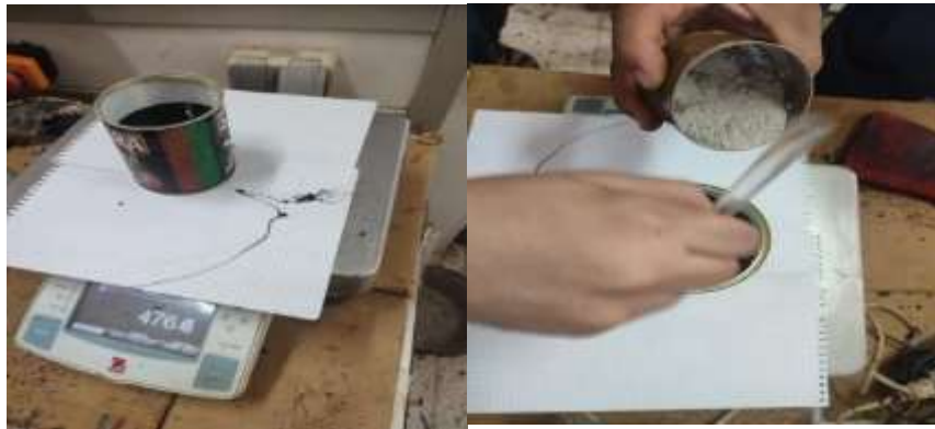
Figure 17 : Préparation du mélange bitume-fillers
