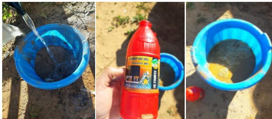
Figure 08 : lavage à l'eau puis à l'esprit de sel.
