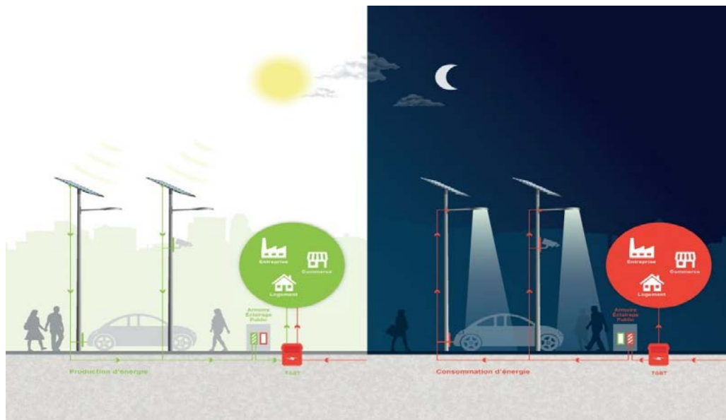
Figure 5 : Éclairage intelligent des rues [10].
