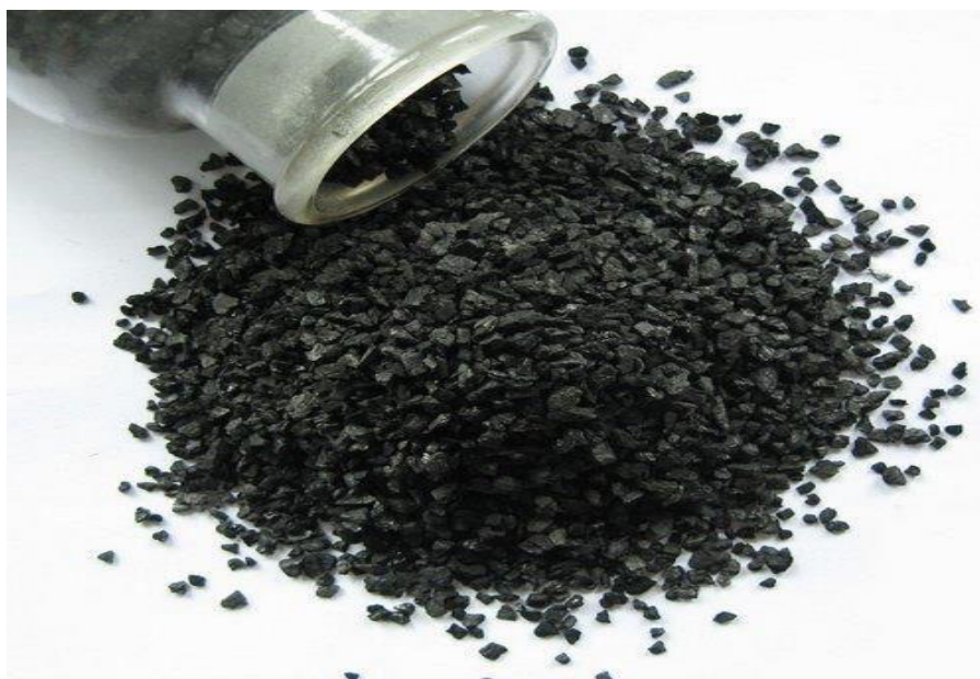
Figure II.2.4.2. Charbon actif en Grain [68]
