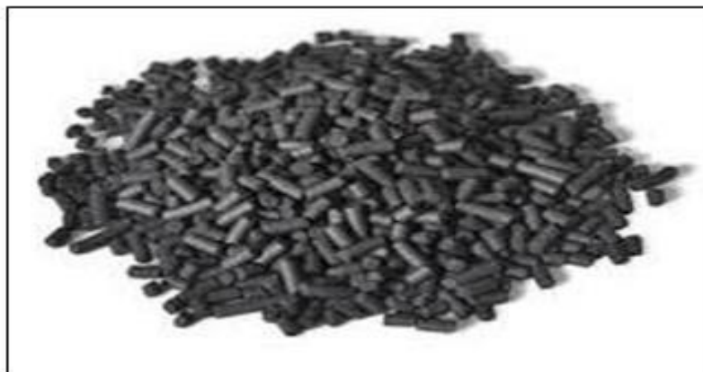
Figure II.2.4.3. Charbon actif en extrudé [69]
