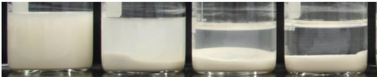
Figure 30 : suspension bentonite /eau avec ou sans chitosane
