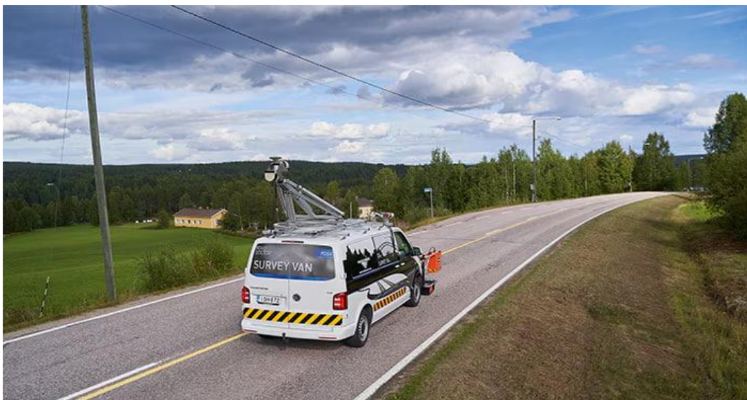
Figure II.14: Détection des dégâts routiers à l'aide de capteurs LIDAR
