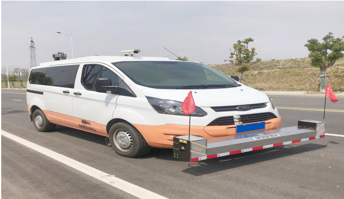
Figure II.12:Évaluation du nivellement de la surface de la route
