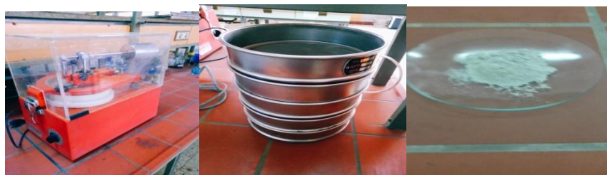
Figure II.2. Préparation de l'argile : broyage et tamisage
