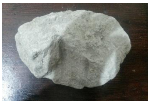
Figure II.1. Argile brute sous forme d'une roche
