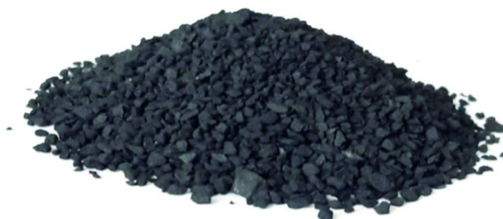
Figure 10 : Charbon actif granulé.
